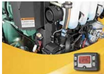
**Sistema de lubricación automática**
