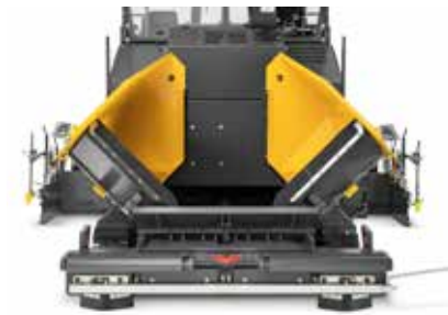
Faldón delantero de accionamiento hidráulico
