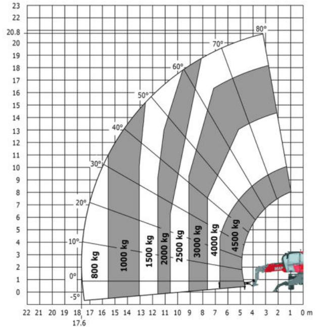
Rotación sobre estabilizadores bajados con plataforma de 365 kg
